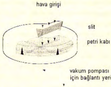
Şekil 2.7: Bir slit samplerin çalışma prensibi
